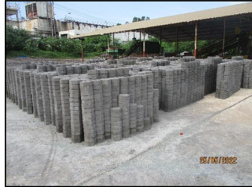
ภาพที่ 2.29 แก้วจากหม้อไอน้ำที่นำกลับมาใช้เป็นส่วนผสมในการทำอิฐบล็อก
